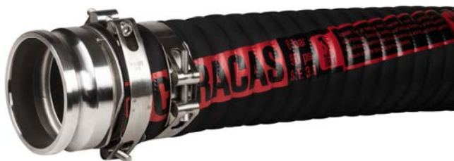
Hadice CARACAS DN102 s nerezovou (AISI 316) spojkou CAMLOCK E 4" (AC-E-400-SS) upevněnou oroustrnými šroubovými sponami z nerezí AISI 316 (AB-DPC-110-120-W5).
