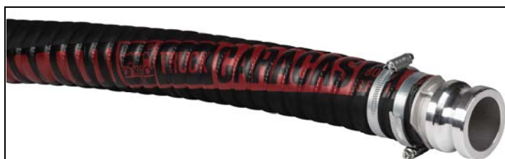
Hadice CARACAS DN51 s hliníkovou spojkou CAMLOCK E 2" (AC-E-200-A) upevněnou šnekovými sponami z pozinkované oceli.
